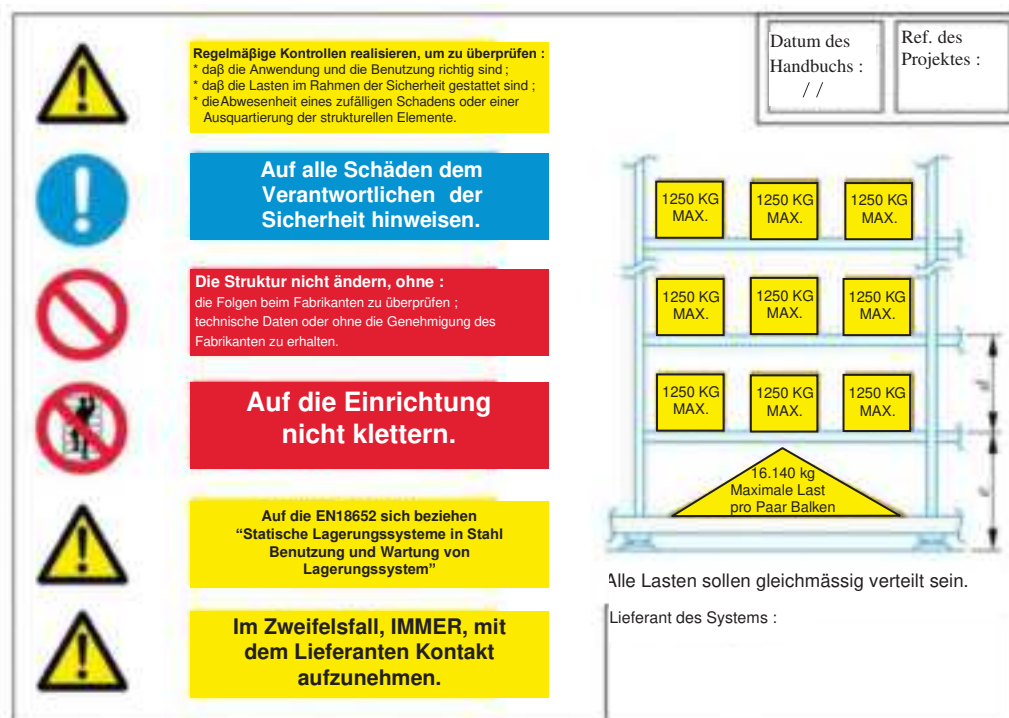
Beispiel eines Tragfähigkeitsschildes gemäß Norm EN 15635
